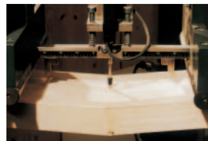
Prova della tenuta della giunzione finger joint
