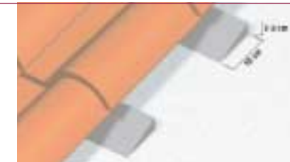
Fig. 5: Dimensioni "tipo" dell'elemento di supporto (cordolo di malta preconstituito) delle tegole. Fig. 5: "Typical" dimensions of the tile support element (pre-cast composition mortar fillet).
